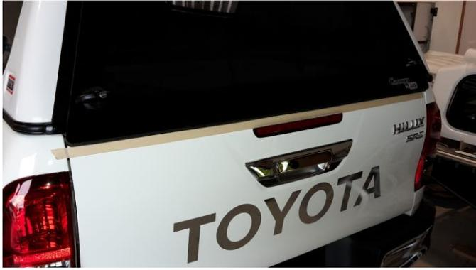
4.11 Kleben Sie Markierungsklebeband auf die Heckklappe, anliegend an die Scheibenunterkante.
