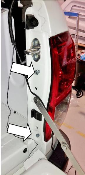
5.0 Lösen Sie die beiden Schrauben, mit der die rechte Heckleuchte am Heck befestigt ist.
