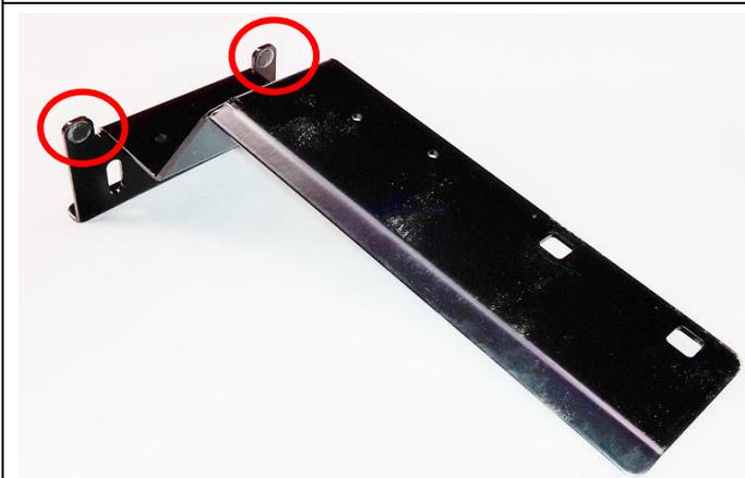
2.13) Bereiten Sie ein Paar Halterungen (3759698R&L) für die Ladeflächenhinterwand vor. Kleben Sie 2 selbstklebende Puffer (665076) auf die beiden abgebildeten Stellen.
