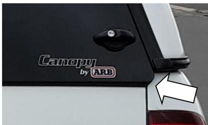
4.9 Schneiden Sie die Dichtungen an der unteren Heckklappe an beiden Seiten so zu, dass sie dem Eckprofil des Fensters folgen.
