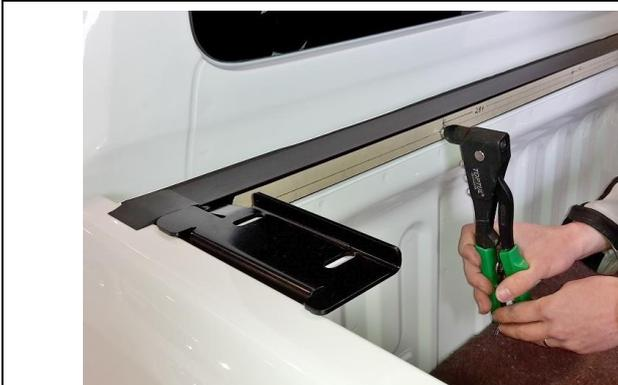
2.12) Entfernen Sie das Markierungsband und montieren Sie die 4 Nieten (6609087) an dem "T"-Träger, um ihn an der vorderen Ladeflächenwand zu fixieren.
