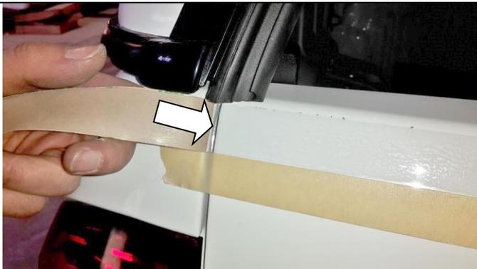
4.13 Drücken Sie gegebenenfalls vorhandene Luftblässchen beim Verkleben langsam weg. Beginnen Sie an einem der Enden und verwenden Sie einen Plastikabzieher. Schneiden Sie das Schutzband an den Außenkanten der Heckklappe ab. Entfernen Sie das Markierungsband nach Abschluss des Klebevorgangs wieder.
