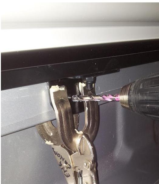
4.4 Bohren Sie ein 6.5mm Loch durch die Halterung (66PD056). Verwenden Sie dabei einen 12mm Bohrtiefenbegrenzer. Entfernen Sie die Bohrspäne.
