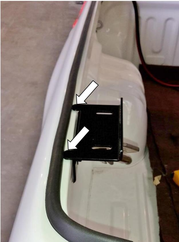
3.1 Führen Sie das Dichtband entlang der Ladeflächenseitenwände. Halten Sie einen Abstand ein, der dem Abstand der hinteren Eckhalterungsaufsätze entspricht. **Drücken Sie das Dichtband fest auf die Ladeflächenwand.**
