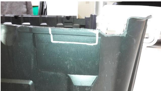
7.6 Nebenstehend abgebildet ist die linke hintere Ecke der Schutzwanne. Markieren Sie den abgebildeten Bereich: 35mm von der Oberkante entfernt, in der hinteren Ecke nach unten führend und von dort 90mm gerade nach vorne führend. Schneiden Sie den markierten Bereich mit Hilfe einer Stichsäge ab und schleifen Sie die Kante mit Sandpapier ab.
