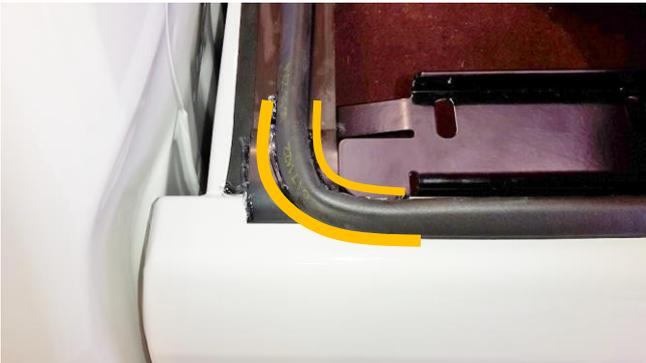
3.7 Bestreichen Sie die Innen- und Außenkanten des Dichtungsbands an den vorderen Ecken mit **transparentem Silikon**. Reinigen Sie überstehende Reste mit einem Lappen und verwenden Sie ggf. Silikonentferner oder Wachs zum entfernen.
