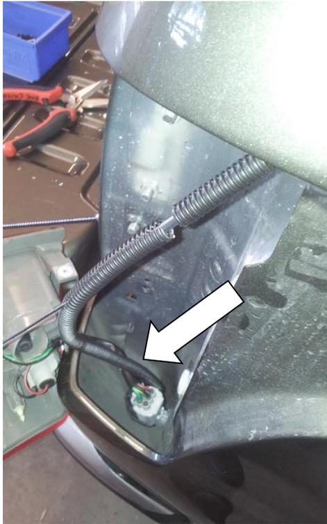
5.3 Stecken Sie einen 10 Meter langen und 10mm starken Kabelkanal (nicht im Lieferumfang) auf die verbleibenden Hardtop-Kabel. Stecken Sie den Kabelkanal anschließend durch den am Boden der Heckleuchte befindlichen Auslass, der zur Unterseite des Fahrzeugs führt.
