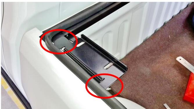
3.3 Ziehen Sie die Dichtung entlang der vorderen Halterungen und halten Sie den gleichen Abstand wie an der Seitenwand ein. Drücken Sie sie fest an. Ziehen Sie den Schutzstreifen nur allmählich ab. Stellen Sie sicher, dass die Innenseite des Dichtungsbands an den Haltepunkten an den vorderen Eckhalterungen anliegt.
