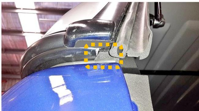
4.10 Während die Heckklappe nach unten geklappt ist und die Hecktüre geöffnet ist, bestreichen Sie die hinteren Ecken um die Halterungen sowie den Bereich zwischen Ladewanne, Heckklappenrahmen und Hardtop-Schienenenträger mit neutralem, transparentem Silikon. Entfernen Sie überstehende Reste und stellen Sie sicher, dass alle Bereiche gut abgedichtet sind
