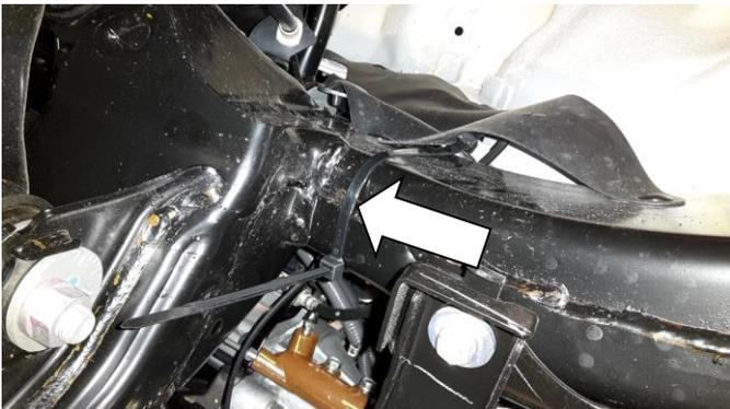
5.12 Verbinden Sie den Kabelkanal mit einem weiteren doppelten 450mm Kabelbinder (2 Kabelbinder werden benötigt) in Richtung Motorraum/hinter dem linken Vorderrad (hinter dem Hitzeschild der Auspuffanlage). **Vermeiden Sie es, den Kabelkanal an den Bremsleitungen zu befestigen und halten Sie Abstand zur Auspuffanlage.**
