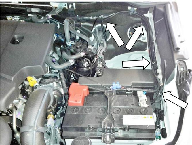
5.13 Ziehen Sie den Kabelkanal weiter nach oben in den Motorraum und bleiben Sie hinter den vorhandenen Fahrzeugkabeln und -leitungen. **Vermeiden Sie es, den Kabelkanal an den Bremsleitungen zu befestigen und halten Sie Abstand zur Auspuffanlage.** Befestigen Sie den Kabelkanal mit 200mm Kabelbindern an 4 Stellen am Haupt-Kabelbaum des Fahrzeugs im linken Eckbereich.
