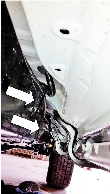
5.11 Das nebenstehende Foto zeigt nach hinten schauend die linke Fahrzeugseite unter dem Schweller. Verbinden Sie den Kabelkanal mit **doppelten** 450mm langen Kabelbindern am linken Schweller in Richtung Vorderrad (6 Kabelbinder werden benötigt). **Vermeiden Sie es, den Kabelkanal an den Bremsleitungen oder der Auspuffanlage zu befestigen.**
