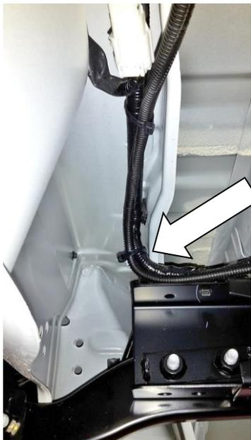
5.6 Binden Sie den Kabelkanal mit 200mm langen Kabelbindern am Fahrzeug-Kabelbaum am linken Eckbereich der Fahrzeugschweller fest.
