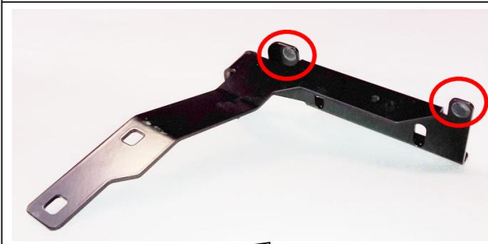
2.3) Kleben Sie an die beiden vorderen Montagehalterungen (3759907R&L), die selbstklebenden Plastikpuffer (665076) – siehe Abbildung.
