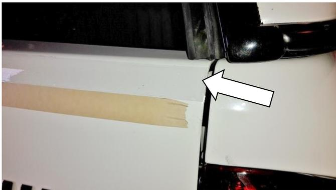
4.12 Beginnen Sie an der Kante der Heckklappe und kleben Sie das durchsichtige Schutzband (665037) langsam auf. Entfernen Sie das Trägerband nur langsam und kleben Sie es Stück-für-Stück auf.
