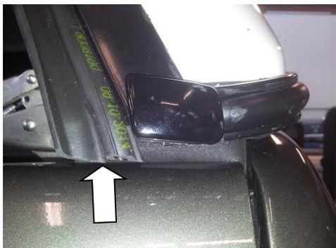
4.8 Schneiden Sie die Dichtungen an der unteren Heckklappe an beiden Seiten passend zu, so dass sie die Oberseite der Heckklappe gerade so berühren.
