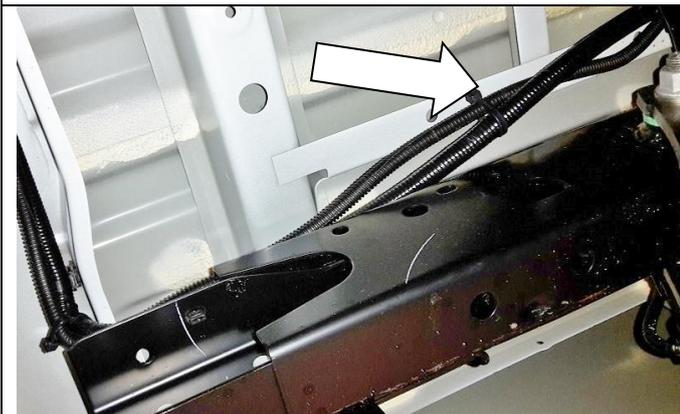
5.7 Verbinden Sie den Kabelkanal mit 200mm Kabelbindern am Fahrzeug-Kabelbaum im Bereich der hinteren Blattfedern.
