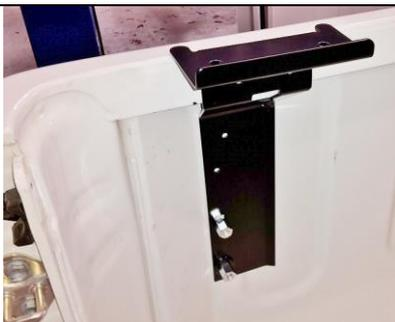
7.9 **Schließen Sie Arbeitsschritt 2.13 zunächst ab.** Schrauben Sie dann den unteren Teil der hinteren Hardtop-Eckhalterungen mit den Schrauben des Schutzwannen-Bausatzes fest. Verwenden Sie eine Distanzscheibe an der **unteren Schraube (wie in Einbauanleitung der Schutzwanne beschrieben, siehe Abbildung links).**
