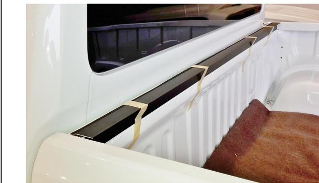
2.2) Verwenden Sie Klebeband, um den T-Träger an seiner Position zu fixieren. **Stellen Sie sicher, dass die Abstände zur Ladeflächenaußenwand an beiden Enden des T-Trägers gleich sind.**
