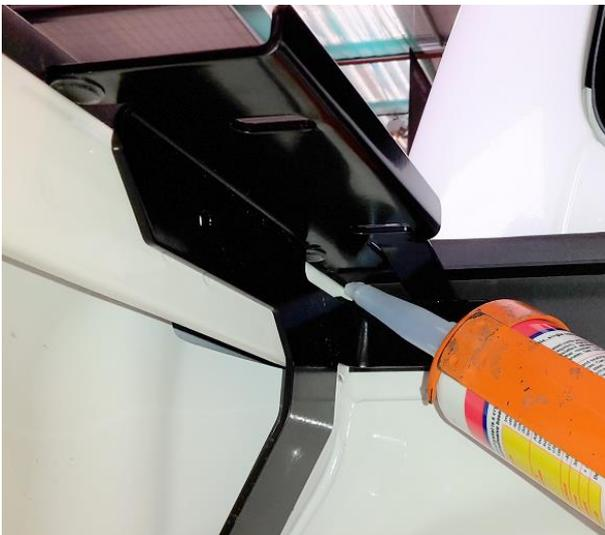
3.8 **Tragen Sie transparentes Silikon an der Innenseite der beiden Enden des T-Trägers auf**. Reinigen Sie überstehende Reste mit einem Lappen und verwenden Sie ggf. Silikonentferner oder Wachs zum entfernen.
