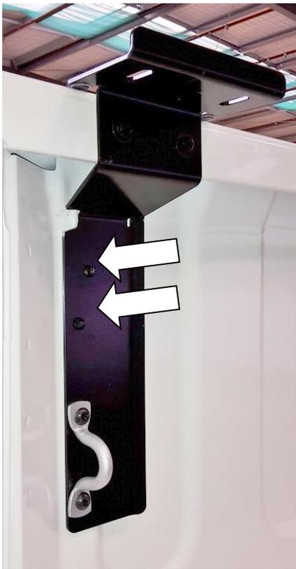
2.18) Stecken Sie zwei Nieten (6609087) durch die hintere Halterung. Wiederholen Sie dies auf der anderen Seite mit der anderen Halterung.
