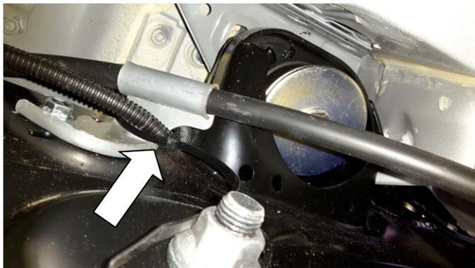
5.9 Verbinden Sie den Kabelkanal mit 200mm Kabelbindern im abgebildeten Bereich in der Nähe der Halterungen am Schweller.
