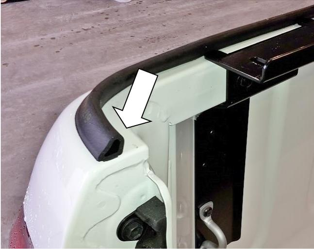
3.0 Aus dem Hardtop-Dichtungsset (6171422) verwenden Sie die Alkoholtücher und reinigen die seitlichen Ladeflächenoberseiten. Kleben Sie das Dichtungsband (9009177) in der abgebildeten Ausrichtung auf. Beginnen Sie beim Verlegen im hinteren Bereich und führen Sie das Dichtungsband an der Innenkante der Ladefläche entlang.
