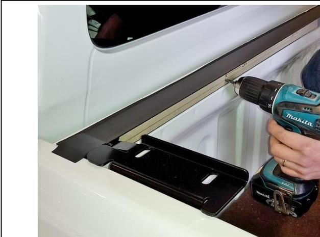
2.11) Bohren Sie an den 4 markierten Punkten 5.2mm starke Löcher durch den T-Träger). Benutzen Sie einen 12mm Bohrtiefenbegrenzer. Entfernen Sie Bohrspäne. Bestreichen Sie die Bohrstellen mit Rostschutzfarbe (665505).
