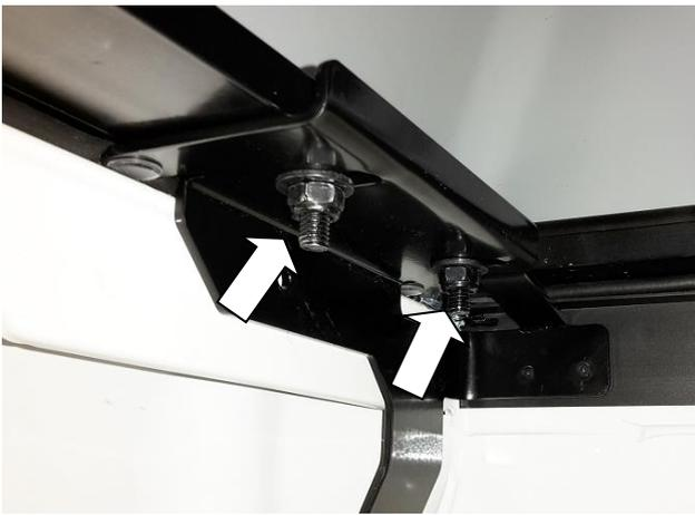
4.2 Stecken Sie durch die Löcher der vorderen Eckhalterungen M8x25mm Schrauben mit M8x20mm Distanzscheiben und weiter durch die Löcher des Hardtop-Schienenträgers. Stecken Sie von der Gegenseite eine M8x20 Distanzscheibe und Nyloc-Mutter dagegen und ziehen Sie alles mit **22Nm fest.**
